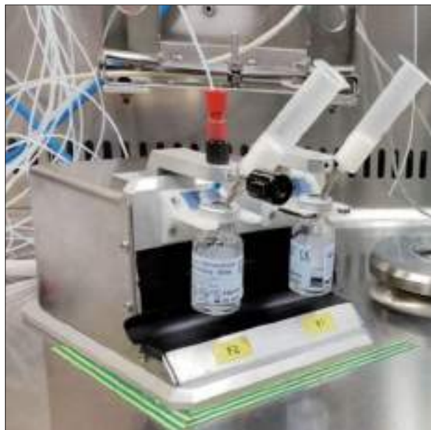
Figura 3. Vial di raccolta del ^{18}\text{F} all'interno della cella calda di manipolazione
