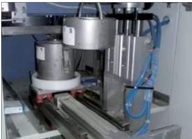
Figura 5. Sistema di chiusura pneumatica automatica del pozzetto di trasporto
